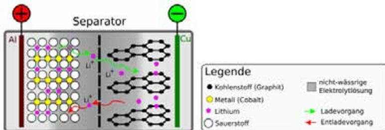
Als **Elektrolyt** wird ein wasserfreies, aber brennbares organisches Lösungsmittel eingesetzt, in dem ein Lithiumsalz gelöst ist. Die Li-Ionen haben eine geringe Größe und hohe Beweglichkeit. Beim Laden des Akkus nimmt der Graphit Lithium-Ionen im Kohlenstoffgitter auf. Beim Entladen werden Lithium-Ionen von den Lithium-Metallociden eingelagert.
