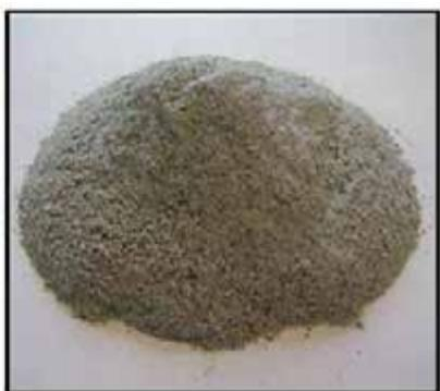
Links: Abstich am Elektrolichtbogenofen, Mitte: Block Co-Ni-Mn-Legierung, Rechts: Li-reicher Flugstaub
